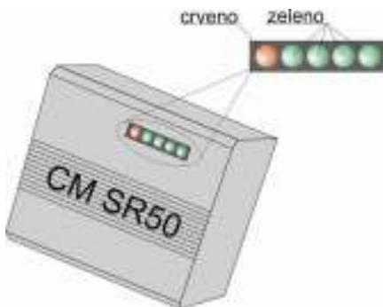
Senzor zapunjavanja u stanju u kojem je registrirao dobavnu cijev zapunjenu peletima (sve LED diode svijetle 10 sekundi bez treperenja, na regulaciji se ispisuje greška E9)
