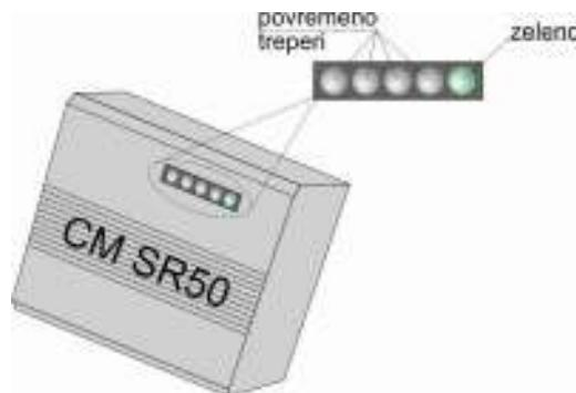
Senzor zapunjavanja u normalnom radu (svijetli jedna zelena LED dioda dok ostale trepere ovisno o količini peleta koja pada kroz dobavnu cijev)
